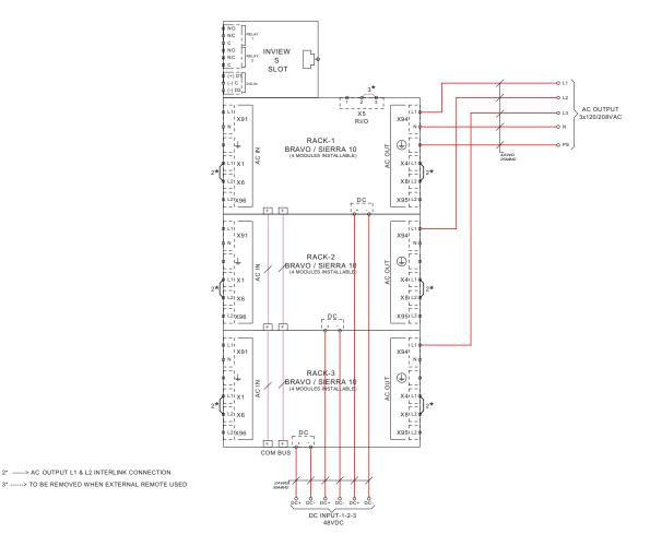
Three phase - REG - Wiring diagram
